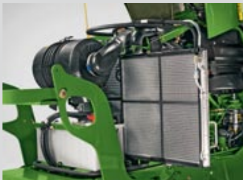
Luftfilter mit Zyklon Staubvorabscheider herausziehbarer Klimakühler mit Schutzgitter für leichtere Wartung
