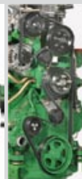
Hocheffizienter Viscolüfter mit großem Durchmesser und wartungsfreien Poly V-Keilriemen Antrieb
